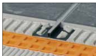
Schlüter®-DILEX-BWS ist ein Bewegungsprofil mit Seitenteilen aus Hart-PVC-Regenerat. Die Bewegungszone besteht aus weichem Kunststoff und bildet die 5 mm breite Sichtfläche. (Produktdatenblatt 4.7)
