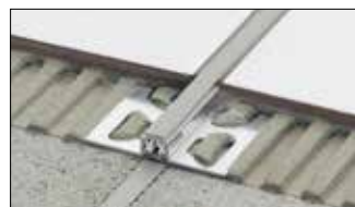
Schlüter®-DILEX-AKWS ist ein Bewegungsprofil mit seitlichen Befestigungsschenkeln aus Aluminium, die mit einer Bewegungszone aus weichem Kunststoff verbunden sind. (Produktdatenblatt 4.18)
